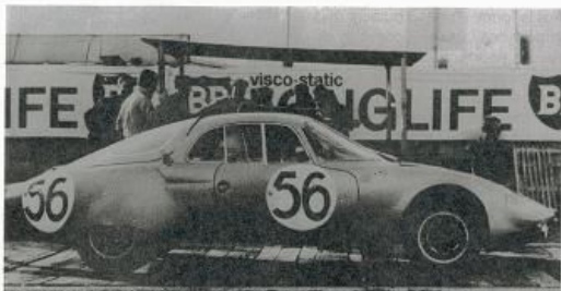
Ultime Djet de course version 1964 à l'aérodynamique encore améliorée, voies très élargies, pare-brise collé, jantes larges de F2 en magnésium à ailettes de refroidissement. Le CX tournait autour de 0,20 autorisant 220 km/h avec le nouveau 1150 cm 3 . Il y avait des châssis tubulaire et des châssis poutre homologués en GT.
