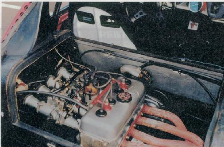
Sur ce document, l'on se rend compte que le moteur en l'occurrence un Gordini 1100 était monté dans l'habitacle. Ceci expliquant cela. D'autant que les généreux carburateurs de 40 n'étaient pas coiffés d'un filtre à air.
