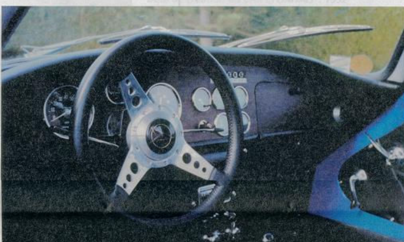
L'intérieur d'un Jet 6 reconnaissable à son petit volant Momo cuir de 35 cm favorisant la position de conduite. Hélas, la console centrale meurtrissait le genou droit des grands gabarits auxquels le Jet était hélas interdit.
